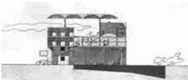
Le Corbusier, proyecto para la casa del señor Chimambhai, Ahmedabad (1952): fachada suroeste. No hay antecedentes en la obra anterior del maestro suizo de bóvedas aéreas como estas, apoyadas en columnas y no en muros de carga. Haría otro proyecto con el mismo recurso constructivo y ambiental, la casa para el señor Hutheesing, el cual tampoco se construiría. (Euvre Complète 1946-1952. © FLC.
